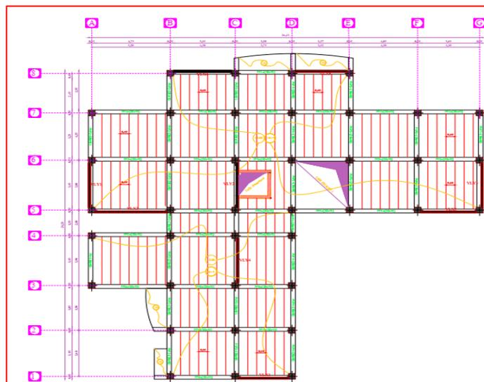
**Figure II.2 :** La disposition de poutrelle.
