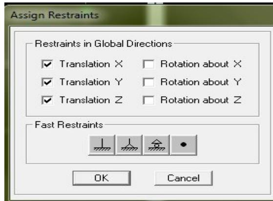
Figure IV.7 : Système d'appuis.
