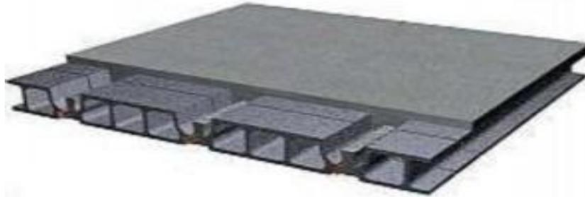
**Figure I.1** : Plancher à corps creux.
