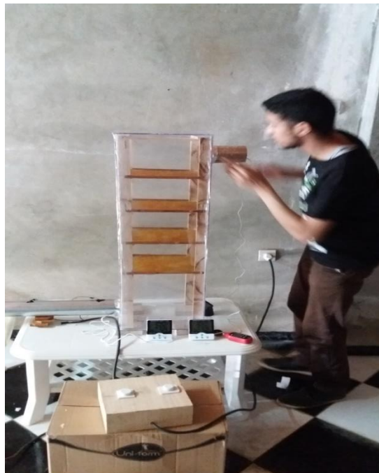
Figure II.6 : Photographie de l'installation de déshumidificateur solide
