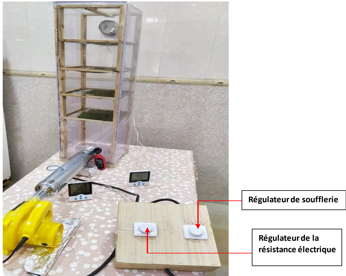
Figure II.13 : Installation de déshumidification à dessiccation solide avec régulateurs
