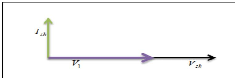
Figure II.9 : Diagramme de Fresnel lorsque  $V_1 < V_{sh}$ .
