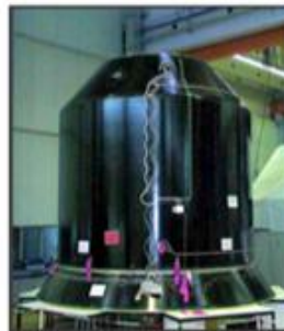
Figure II.1 : Quelques applications des matériaux composites : (a) un catamaran, (b) le support de la charge utile d'Ariane 5 (image) (c) des skis de compétition (image de Thomas Grollier).
