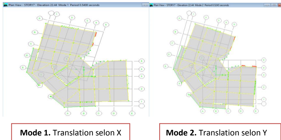
Figure 4.9. Modèle final de disposition des voiles.
