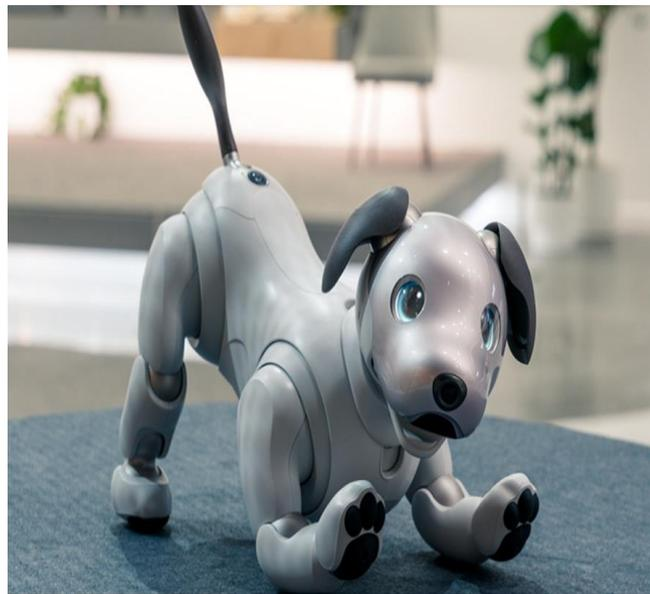
Figure I.18 : Robot mobile à pattes
