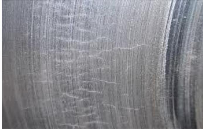
**Figure I.16:** Ramification de fissure, phénomène appelé faïençage [7]
