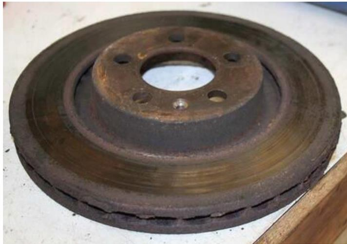
**Figure I.18** : Disque de frein rouillé [11]
