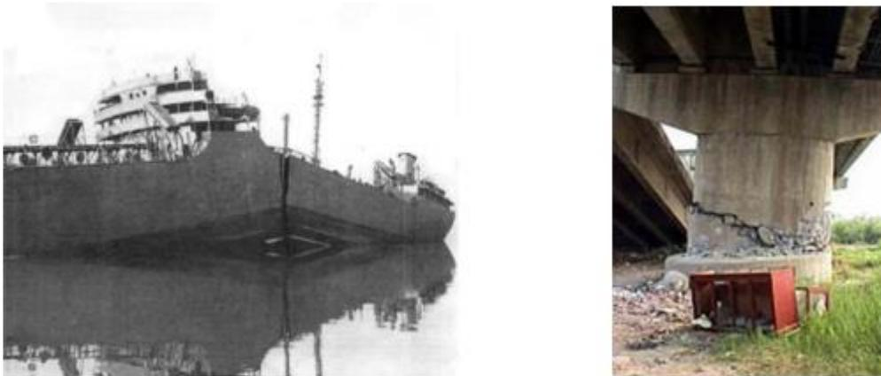
**Figure I.14.** Rupture fragile d'un liberty-ship (seconde guerre mondiale) au cours d'un hiver rigoureux, et Rupture d'un autopont lors d'un tremblement de terre.[15]
