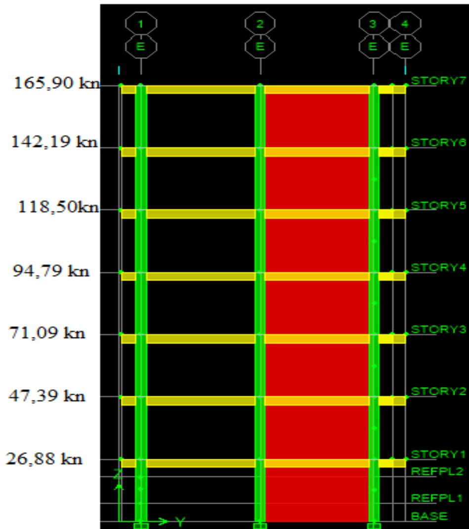
**Figure III.9 :** Forces sismiques sur files intermédiaires avec voiles sens YY.
