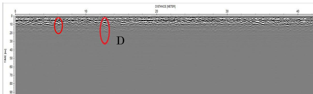
Figure3.4: Illustration de l'anomalie (D) révélé par le profil 4.
