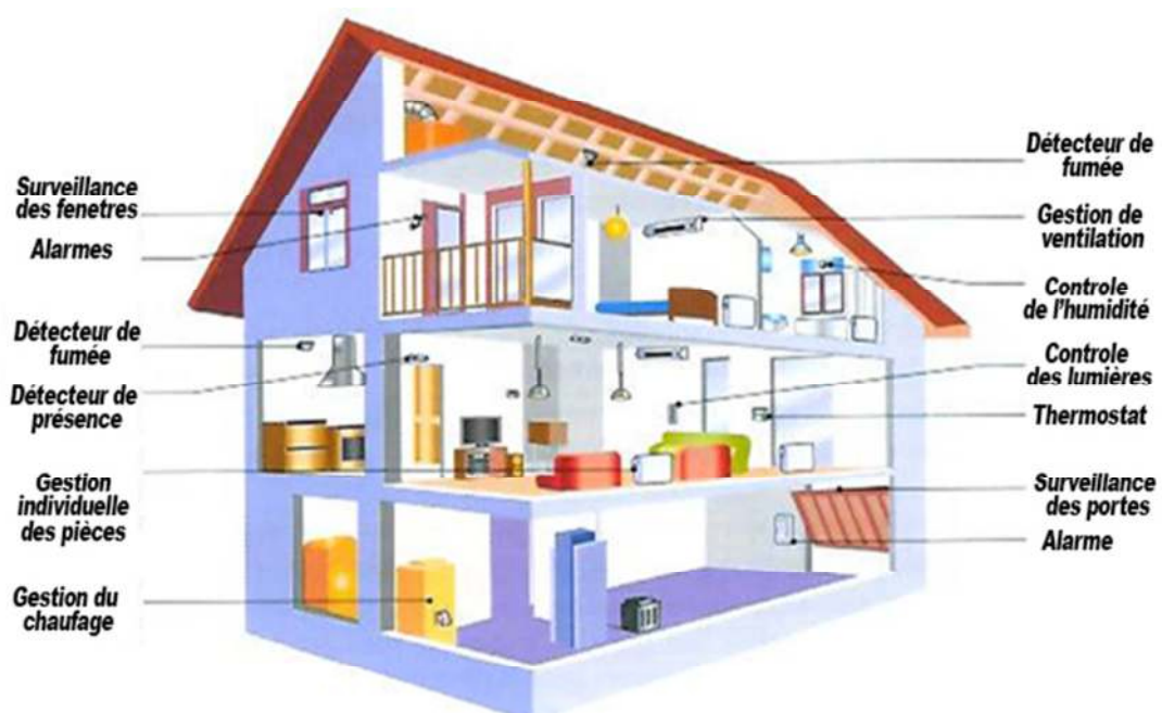
Fig.2.15: Les services de la domotique.
