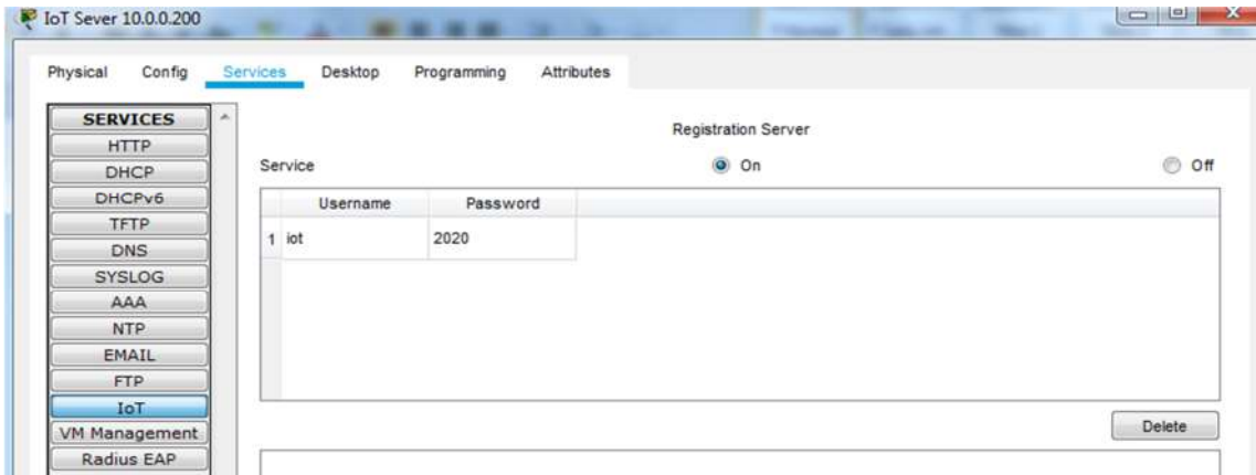
Fig.3.7: Activation du serveur IoT
