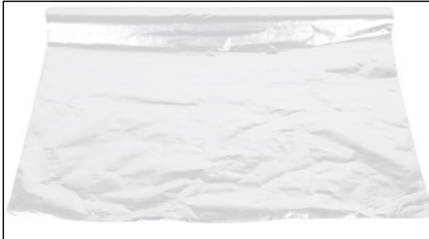
Figure 2.31 : feuille d'aluminium de 0,02 mm d'épaisseur
