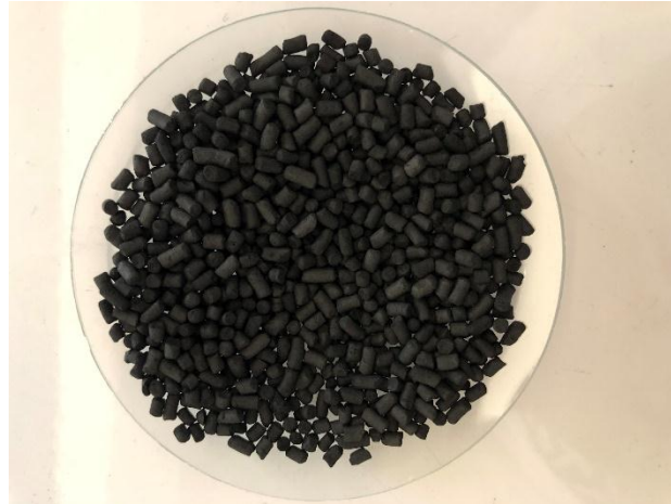
Figure 14: Texture du charbon actif en extrudé
