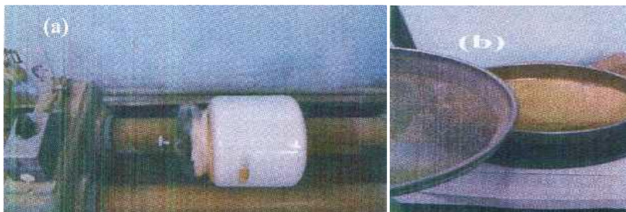
Figure 9: (a) Photographie d'un broyeur de laboratoire, (b) La poudre de cactus après broyage et tamisage [66].
