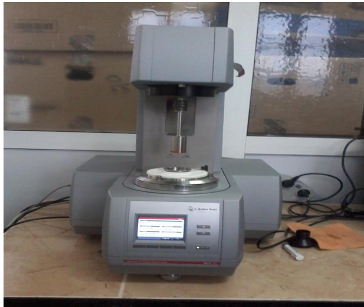
Figure IV.1: Rhéomètre Anton Paar MRC 302.
