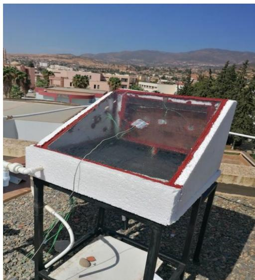
Figure II.5 le distillateur solaire avec chambre de condensation
