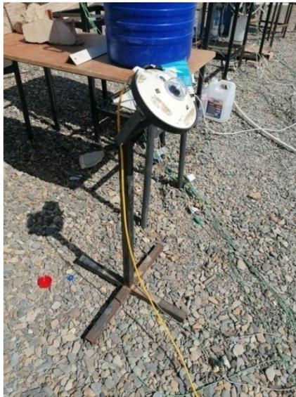
Figure II.11 Pyranomètre de type PYRANOMETRE TYPE CMP 11
