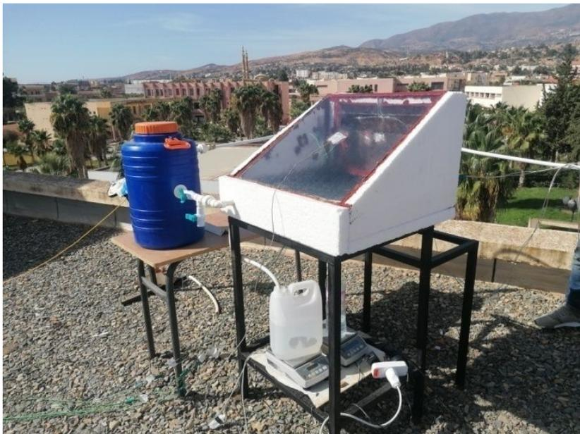
Figure II.1 Le banc d'essai du système de distillation
