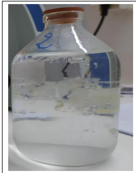
Figure III.13 : Echantillon de l'eau usée après distillation solaire
