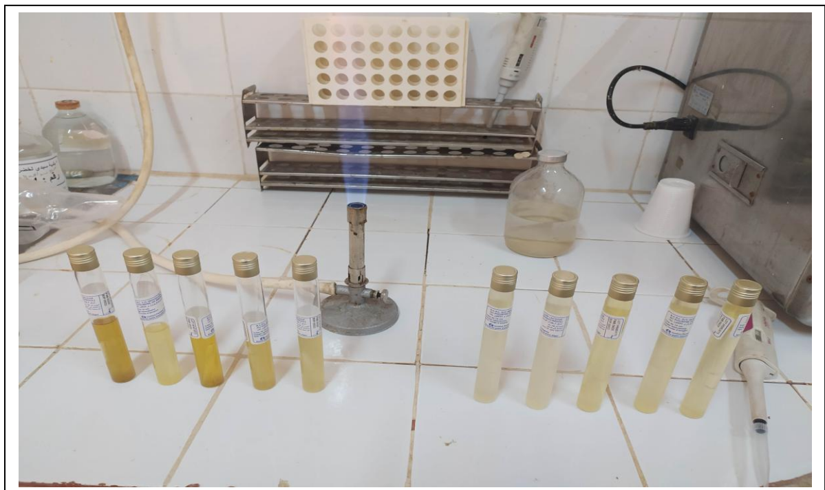
Figure III.16: Photo de résultat test de présomption par bouillon lactosé
