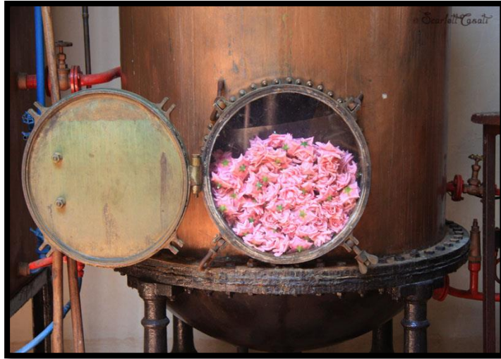
Figure I.10: Extraction par enfleurage à chaud.
