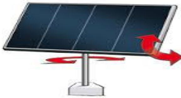
Figure XXIII.4: système poursuit soleil bi-axial
