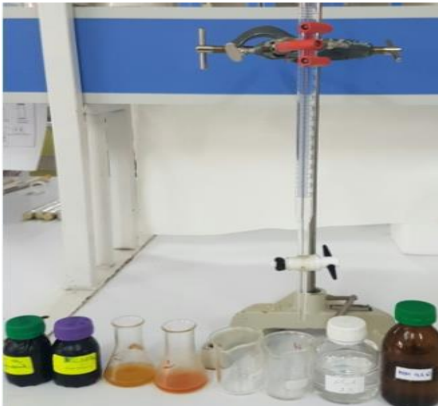
Figure III.5 : Dispositif de mesure d'indice d'acide
