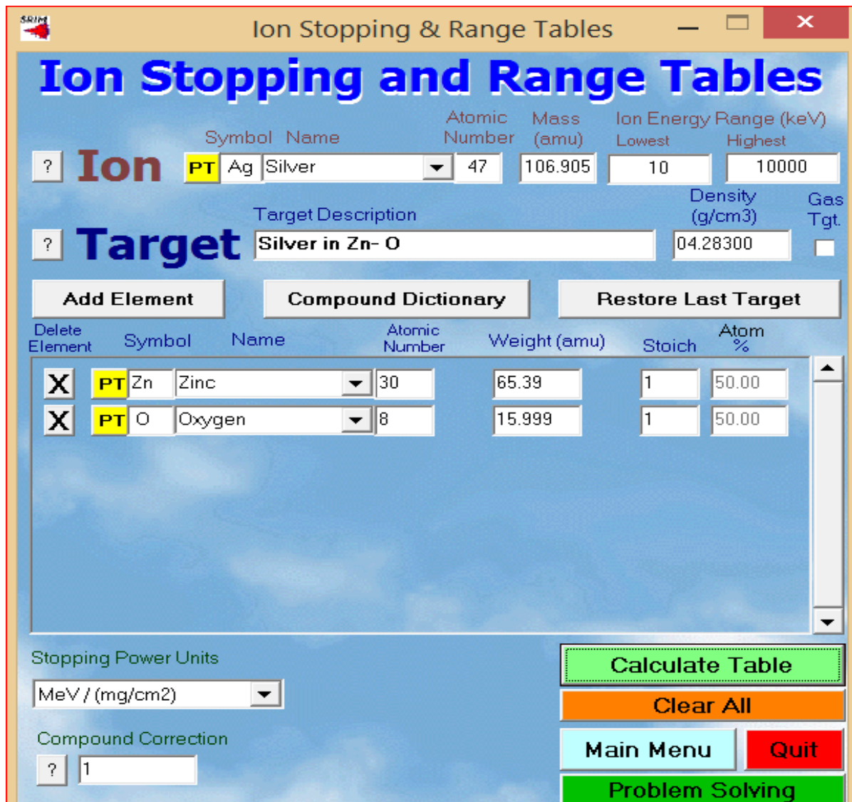
Figure II-2 Tableau de commande du logiciel pour le pouvoir d'arrêt électronique et nucléaire
