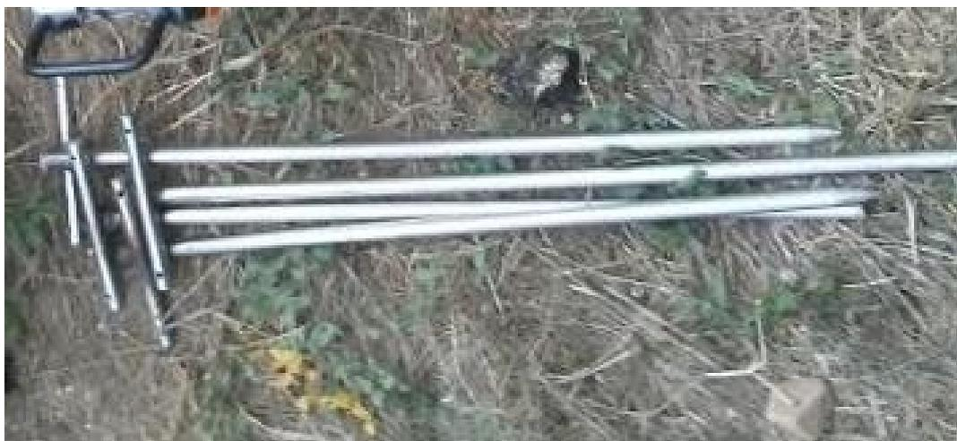
*Figure 3-4 : Electrodes de mesures.*
