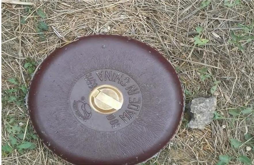
*Figure 3- 5: Un mètre ruban pour les mesures des distances.*
