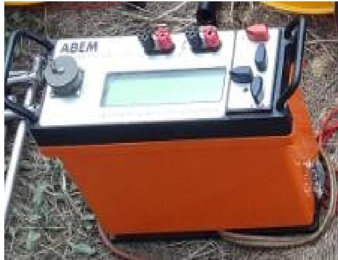
*Figure 3- 2 : Résistivimètre ABEM.*
