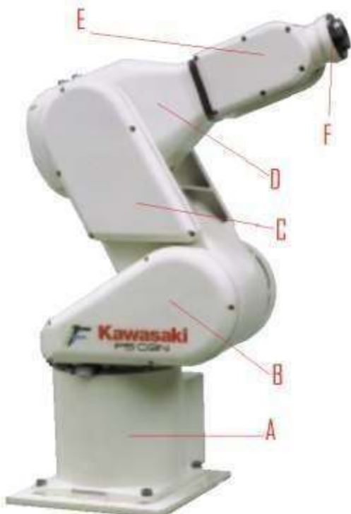
Figure 2.1 : les parties du robot [16]
