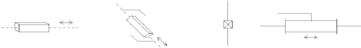
Figure 1.5 : Symbole de l'articulation prismatique [3]
