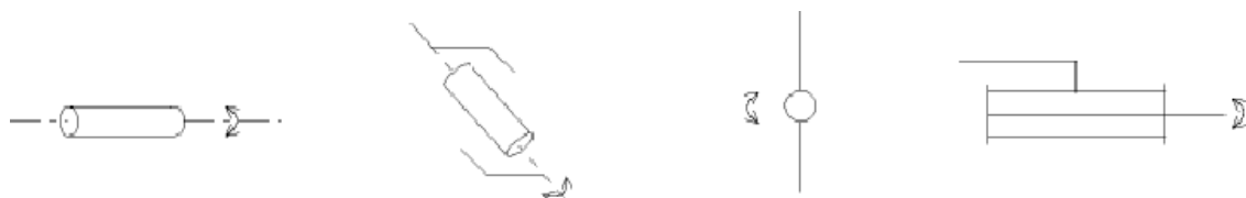
Figure 1.4 : Symbole de l'articulation rotoïde [3]
