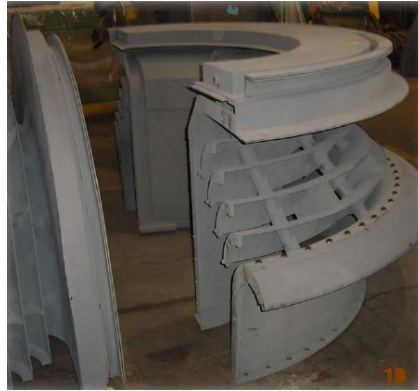
Figure II-27: Diffuseur des gaz d'échappement
