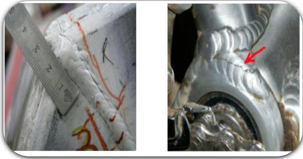
Figure IV.14 : Exemples de fissures sur aluminium [37].
