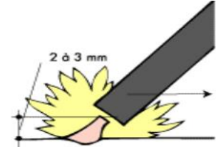
Figure IV.9 : Rapprocher l'électrode de 2 à 3 mm de la pièce et commencer le soudage.
