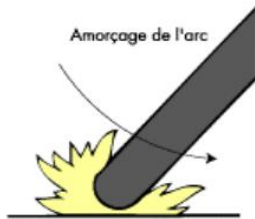
Figure IV.7 : frotter le bout de l'électrode sur la pièce à souder sur 1 ou 2 cm, ce qui produit des étincelles.
