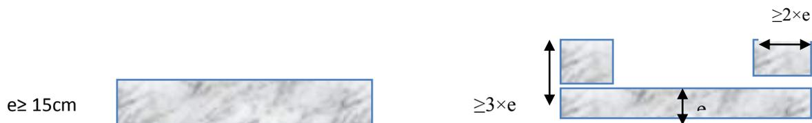
Figure V.6. Schéma de Voile simple.
