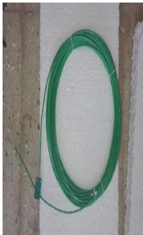
Figure II-6 : photographie du thermocouple
