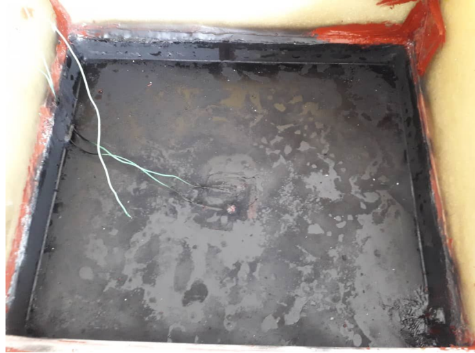
Figure II-2 : Photographie de l'absorbeur du distillateur peint en noir mate
