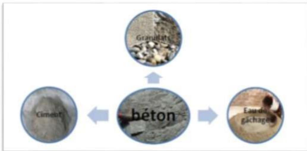
**Figure I.3** : Les composants du béton.
