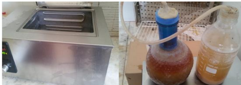
Figure III.6 : Le bain-marie et le réacteur de fermentation [45].
