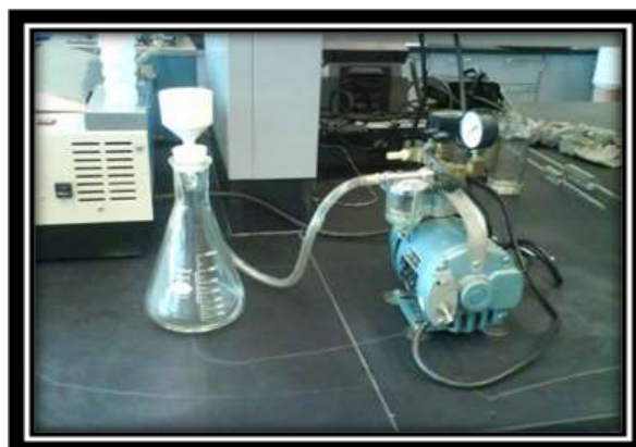
Photo 13 : Pompe à vide.
