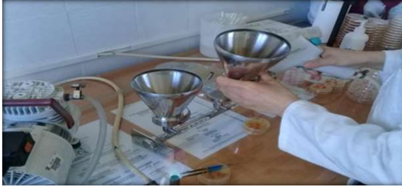
Photo 12 : Rampe de filtration.
