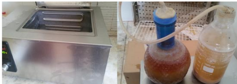
Figure III.6 : Le bain-marie et le réacteur de fermentation [45].
