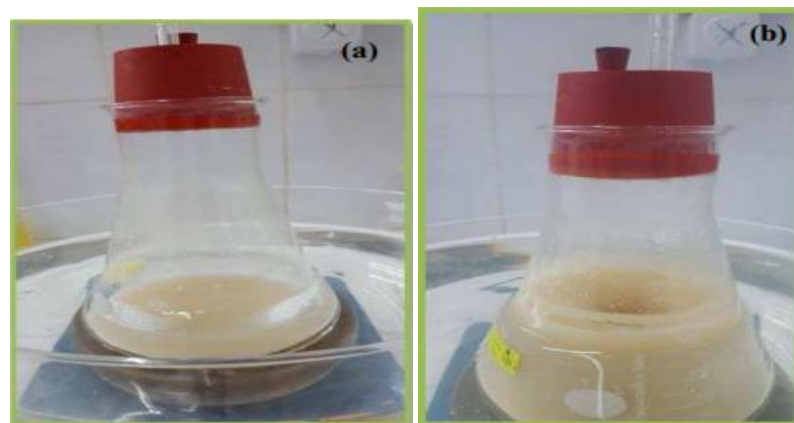
Figure IV. 7 : Ecume formée durant la fermentation des mouts de datte (a) Moût de dattes concentré (b) Moût de dattes dilué [20].
