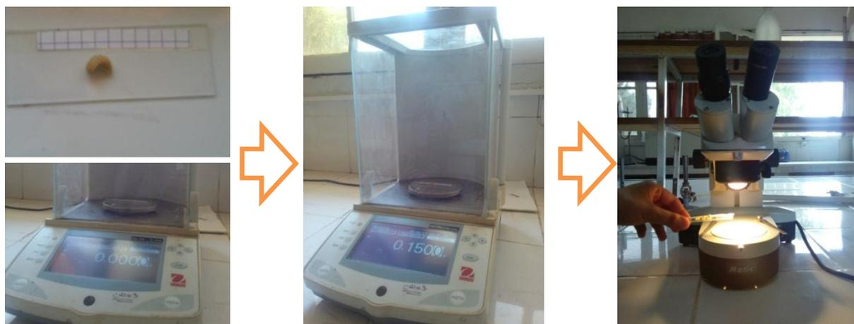
**Figure 09 :** Pesée des larves et prise de photographies sous la loupe binoculaire.
