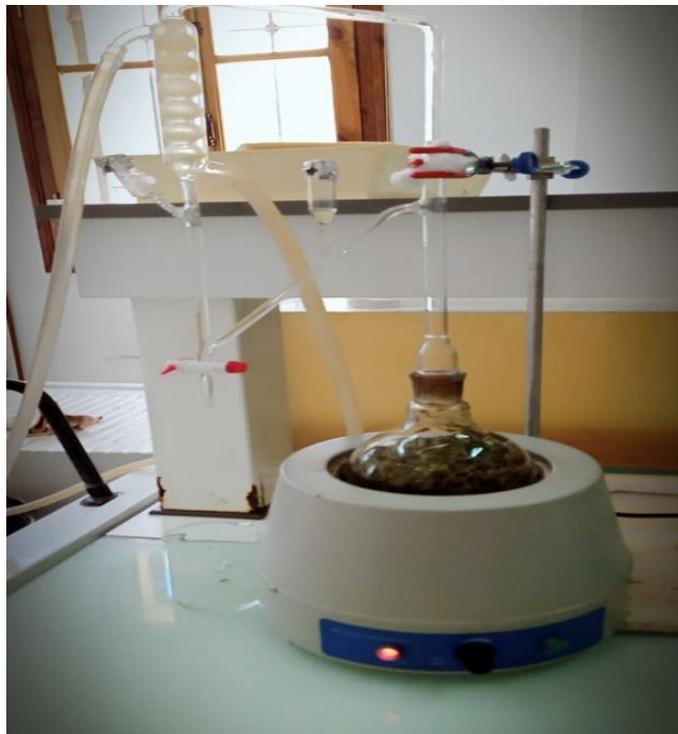
Figure 05 :Dispositif d'extraction à laide d'un hydrodistillateur du type (Clevenger)
