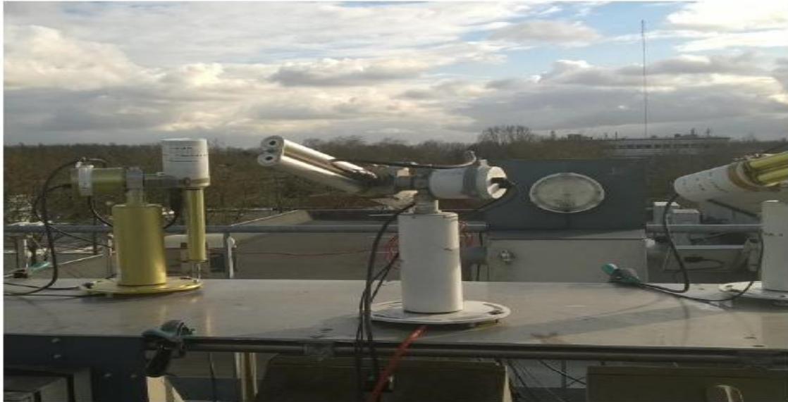
Figure 17: Station de mesure AERONET sur le toit du LOA (laboratoire d'optique atmosphérique) à Lille.
