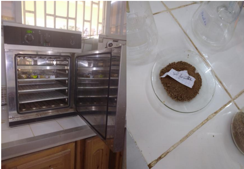
Photo 03 : La méthodologie de mesure l'humidité (Cliché par Boubekeur. S).
