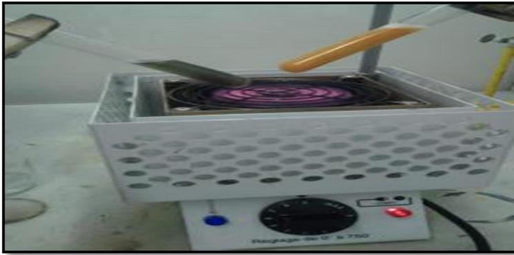
Figure IV .11 : Plaque chauffante pour chauffer nos tubes. [60]
