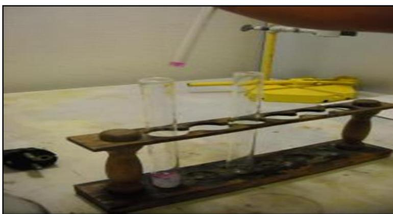
Figure. IV.12 : Ajouter réactif de permanganate de potassium. [60]
