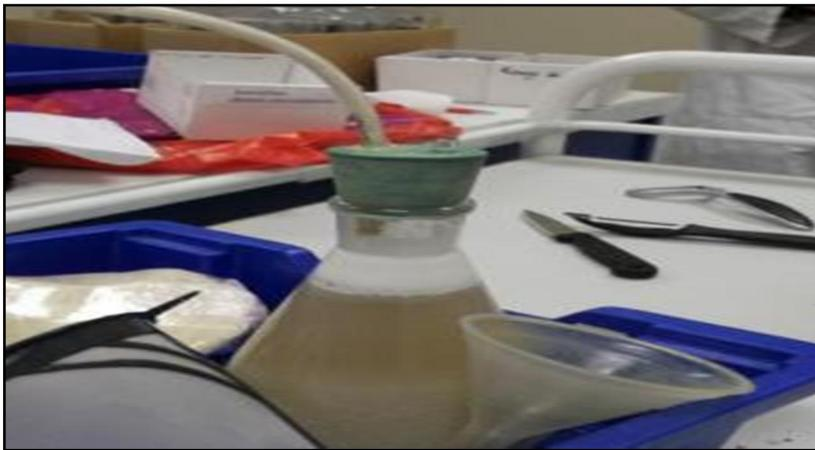
**Figure IV.9 :** Bouchon muni d'un tuyau à dégagement.[60]
