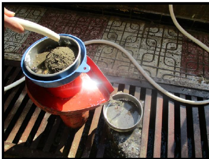
**Figure 21.** Extraction des kystes de *Globodera* par l'appareil de Fenwick (originale).
