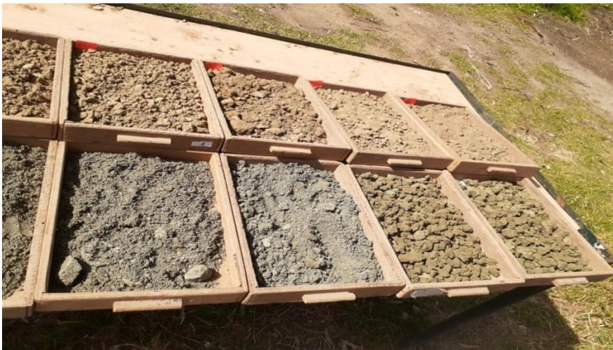
**Figure 5.**Séchage des échantillons a l'air libre (Cliché : HammiMedjdoub 2020)
