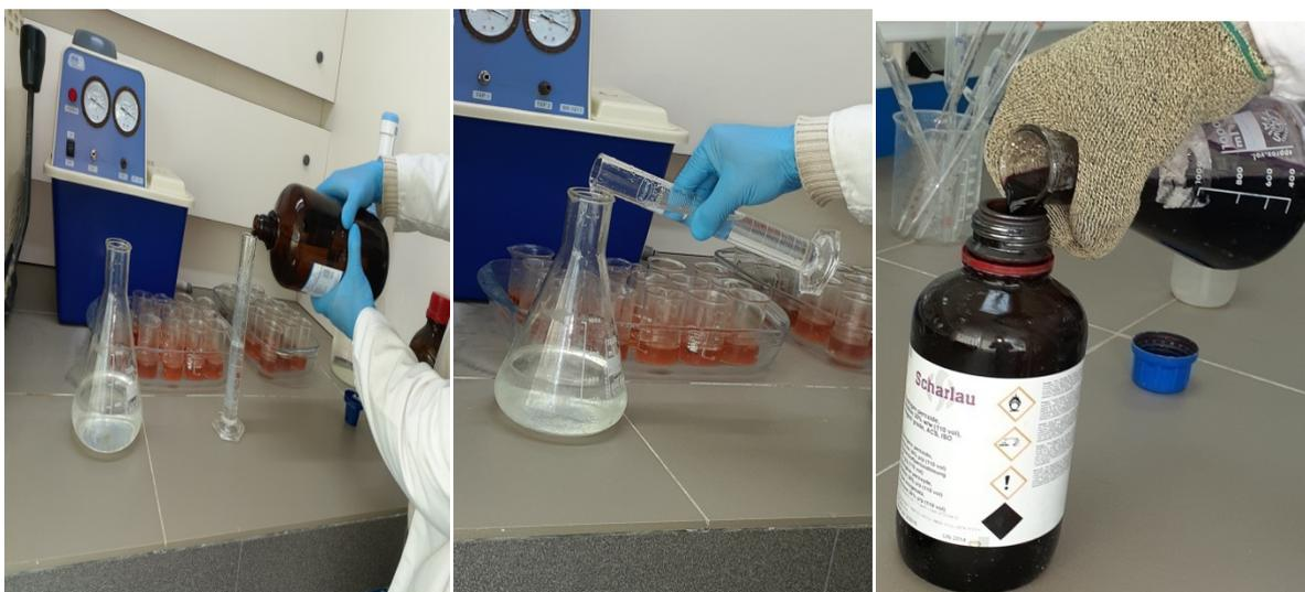
Préparation de solution de permanganate  $\text{KMnO}_4$  (Mars 2020)
