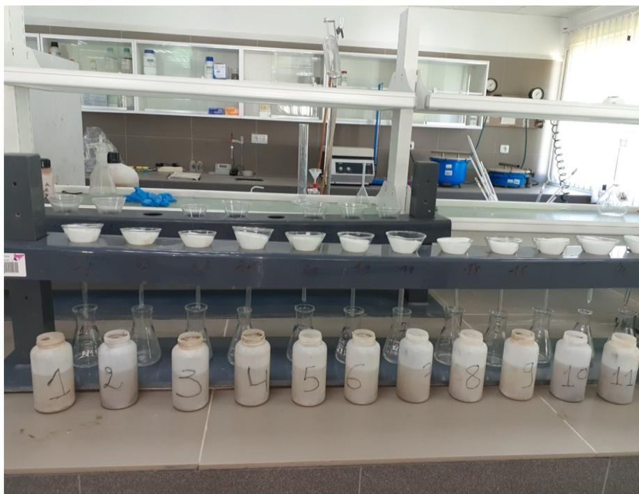
**Figure 15.** Analyse de phosphore (Etape de filtration par papier filtre sans cendres) (Cliché HammiMedjdoub, 2020)
