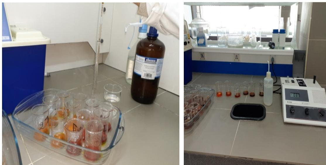
**Figure 12.**Mesure de la MO par colorimètre (Cliché HammiMedjdoub, 2020)
