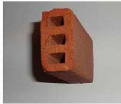
**Figure 12.** Briques fabriquées avec un taux de substitution de 70% de sédiments (**Boukemmoum, 2019**)
