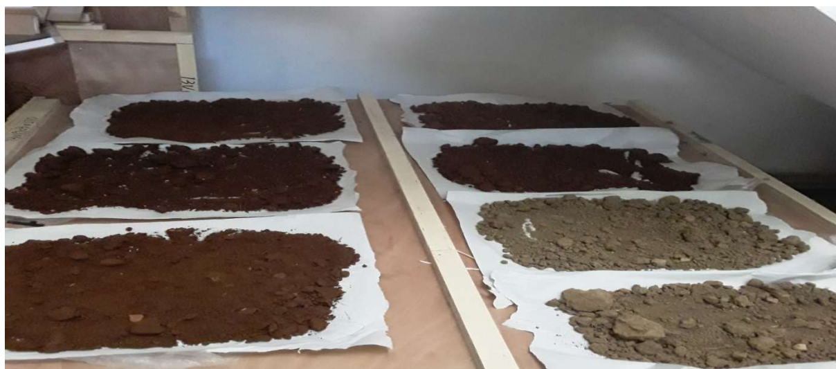
Figure N°14: Séchage des échantillons à l'air libre (Cliché de Djihane et Hanane 04 mars 2020).
