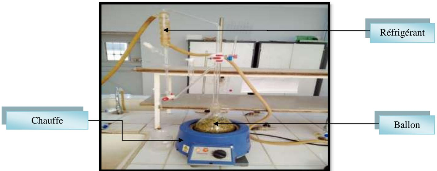
**Figure 18:** Appareil d'hydro distillation de type Clevenger
