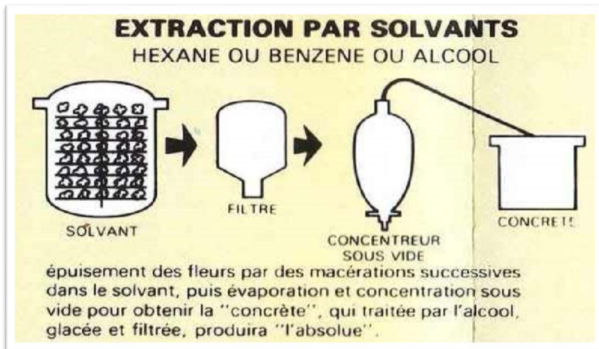
Figure 13 : Technique d'extraction par solvant (Anonyme 7).
