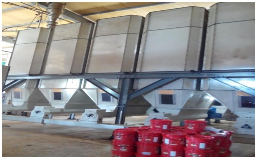
Figure n°17: Silos de dégazage
