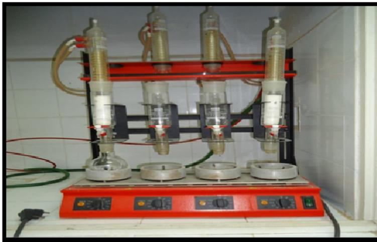
**Photo 7.** Appareil de Soxhlet.
