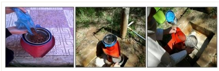
Figure 17 : Extraction de nématodes à kystes à l'aide de l'appareil de Fenwick (Original).
