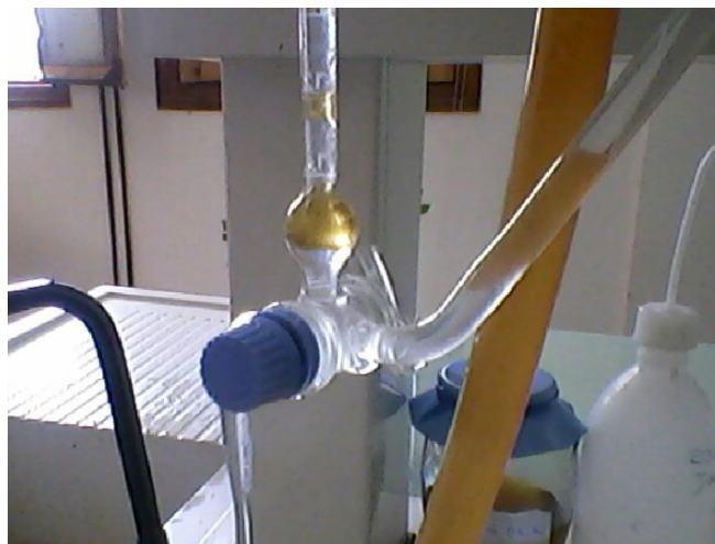
Figure n°06 : Dispositif de récupération de l'huile essentielle (photo originale)
