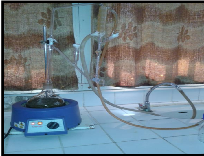
Figure 37: Hydrodistillateur de type Clevenger (Originale, 2016)
