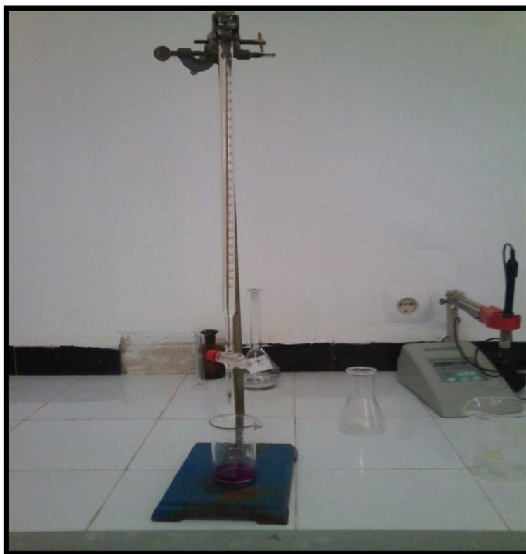
**Figure 3.3 :** Dispositif de mesure d'indice d'acide
