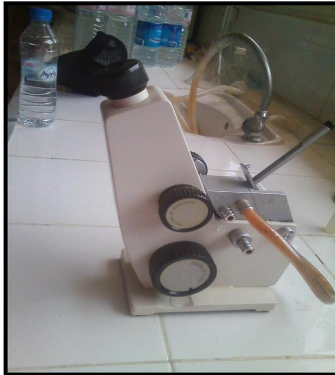
**Figure 3.2** : Réfractomètre d'ABBE.
