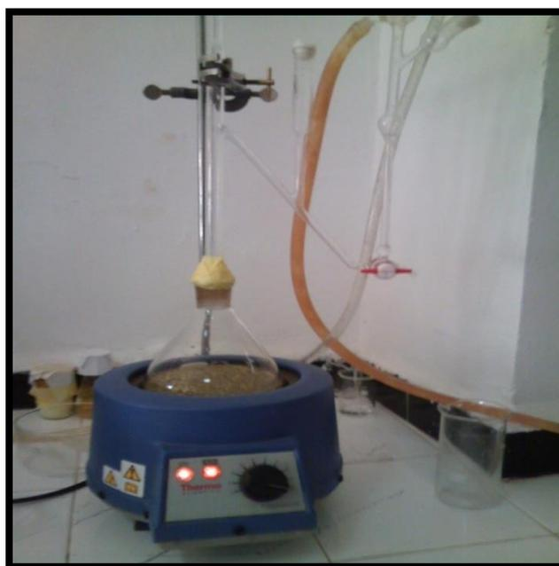
**Figure 3.1:** Montage d'hydrodistillation manipulé (*Clvenger*)
