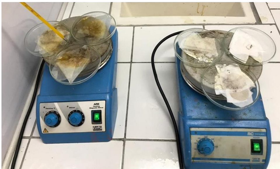
Figure 20 : Procédé de la digestion acide sur plaque chauffante a une température contrôlée.
