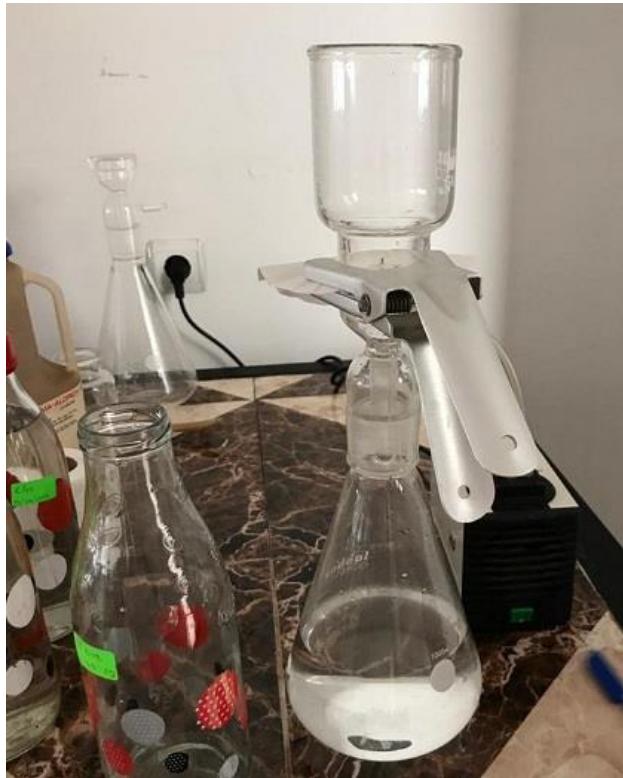
Figure 19: Dispositif de la filtration sous vide.
