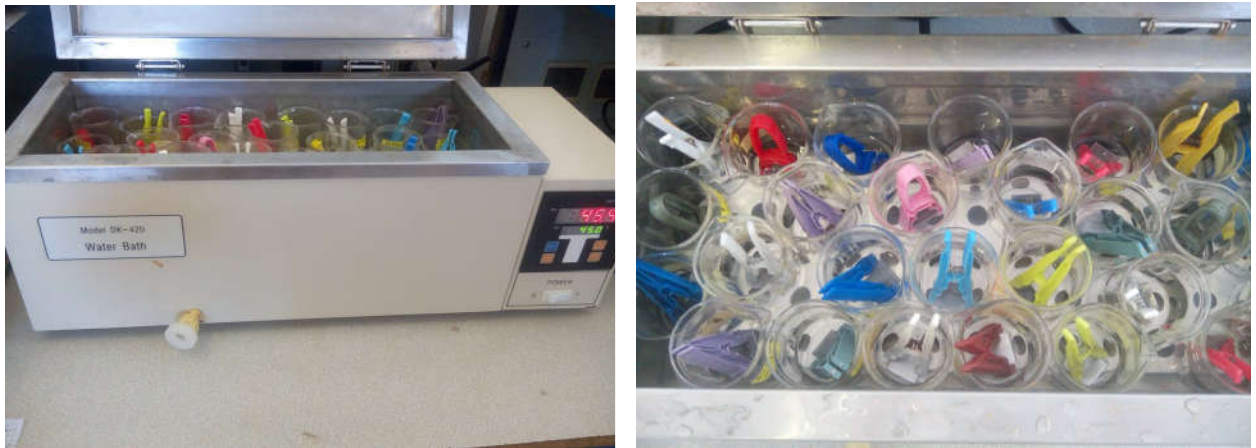
Figure II-2. Image photographique des échantillons dans le bain marie
